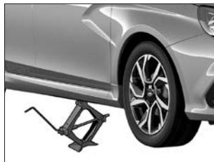
Рис. 2. Положение домкрата при замене колеса
